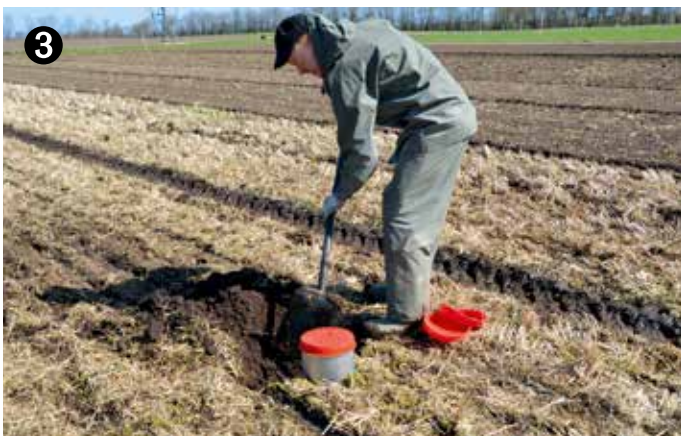
Dans le but d'extraire des colonnes de sol intactes sur 18 cm de profondeur, un vérin hydraulique est utilisé (photos 1 et 2, dans le champ labouré). L'excavation est réalisée à la pelle (photo 3, dans le champ en semis direct) et les colonnes sont incubées en laboratoire (photo 4). Cette opération a eu lieu au printemps.
