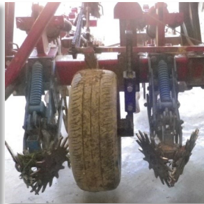
Outils de Strip-till et aperçu du travail après passage dans un couvert de moutarde
