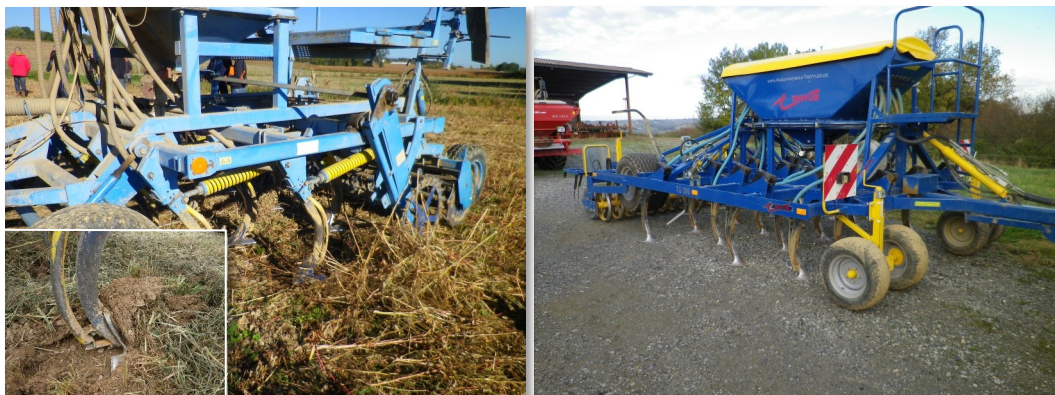
Semoir type EcoDyn et son soc à ailettes (à gauche) et semoir Treffler TG300 (en droite).
