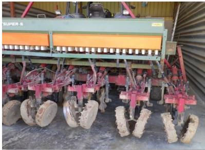
Outils de Strip-till et aperçu du travail après passage dans un couvert de moutarde
